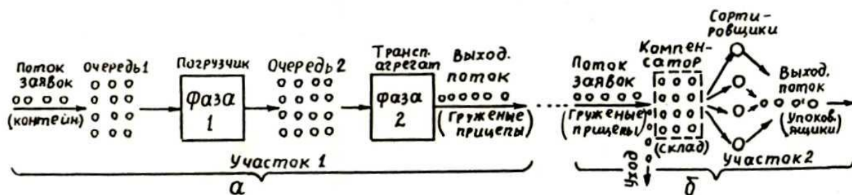
Рисунок 1 – Принципиальная схема функционирования СМО уборки, транспортировки и сортирования фруктов
